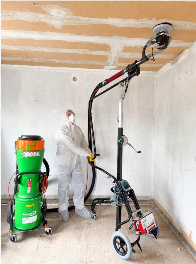
Die Deckenschleifmaschine Fouine mit 165 mm Ø und Brushless Motor, läuft ohne Vibration. Die manuelle Einstellung der Arbeitshöhe wird durch ein Kurbelsystem erleichtert. Das Fahrgestell Eland ist sehr stabil und einfach lenkbar. Die maximale Arbeitshöhe beträgt 3,80 m, eine Breite von 0,70 m garantiert jeden Türdurchgang.
